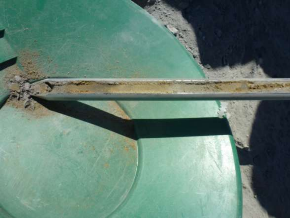
Foto 22: Proceso de Toma de Muestras desde Relaves Planta Bellavista, San Felipe, material de muestra en la sonda
