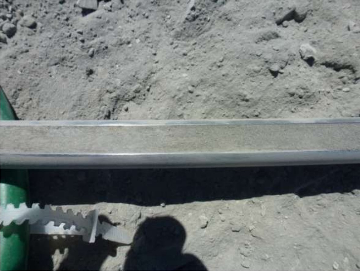
Foto 21: Proceso de Toma de Muestras desde Relaves Planta Bellavista, San Felipe, material de muestra en la sonda
