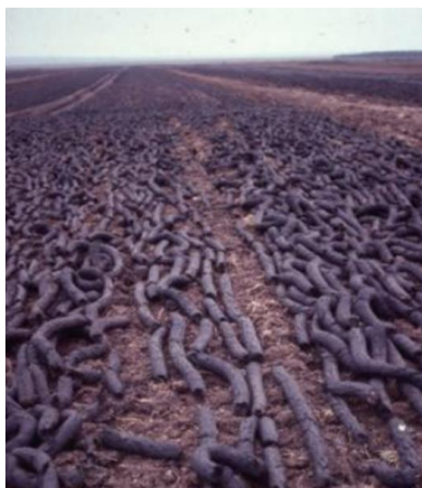
Figura 2-7. Fotografía de turbera explotada en Reino Unido con método de corte de “salchicha”.
