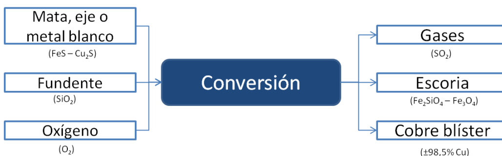
Figura 3 Esquema de insumos y productos del proceso de conversión de mata de cobre. Fuente: elaboración propia.
