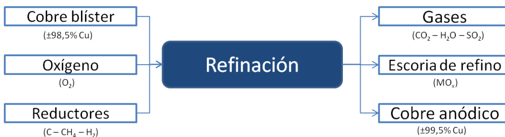
Figura 4 Esquema de insumos y productos del proceso de refinación de cobre blíster. Fuente: elaboración propia.
