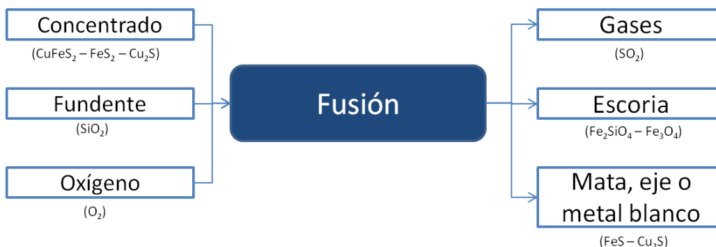
Figura 2 Esquema de insumos y productos del proceso de fusión de concentrados de cobre. Fuente: elaboración propia.
