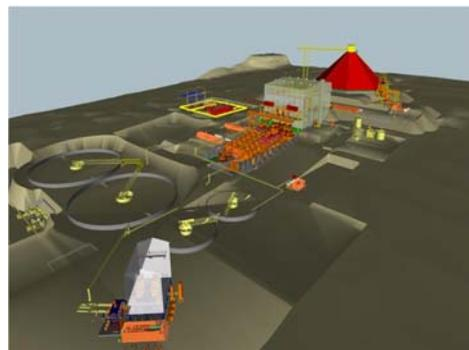
Dado el alto contenido de arsénico en el mineral, se requerirá de un tratamiento de sus concentrados mediante un proceso de tostación en lecho fluidizado (hasta 350 Kton por año de concentrados), del cual se obtendría un concentrado de alta ley (37% de Cu fino contenido) que opcionalmente alimentaría a la fundición y/o se comercializaría. La planta de tostación incluye la necesaria planta de ácido sulfúrico para el abatimiento de los gases sulfurados.
