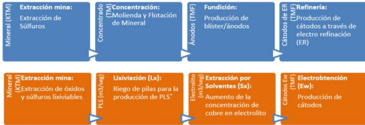
Figura 2: Procesos productivo de la minería del cobre
