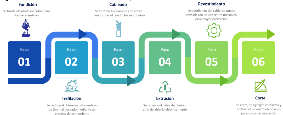
Figura 17: Proceso de fabricación de cables de cobre a partir de cátodos
